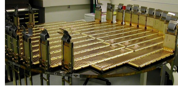
Fig. 5.1: Un plan du STD en cours d'assemblage. On remarque nettement les lames qui sont elles-mêmes couvertes des capteurs silicium.
