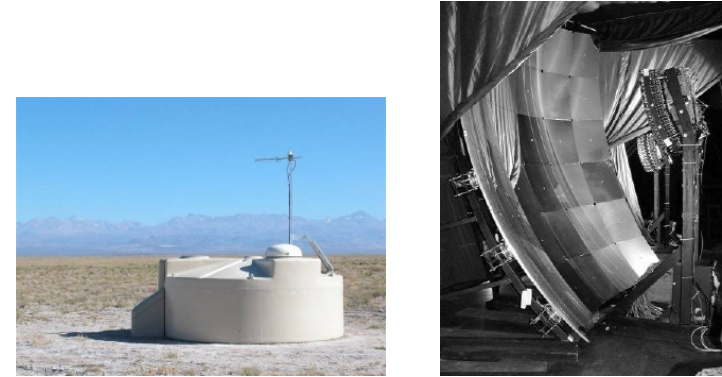
Fig. 1.15: Un des 1600 détecteurs d'Auger installé dans la Pampa Argentine. Il s'agit en fait d'une cuve contenant 12 t d'eau et équipée de trois photomultiplicateurs. L'image de droite montre un télescope à fluorescence. D'après [33].
