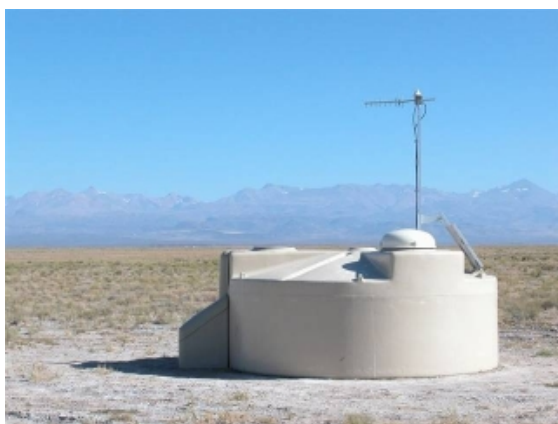
Fig. 1.15: Un des 1600 détecteurs d'Auger installé dans la Pampa Argentine. Il s'agit en fait d'une cuve contenant 12 t d'eau et équipée de trois photomultiplicateurs. L'image de droite montre un télescope à fluorescence. D'après [33].
